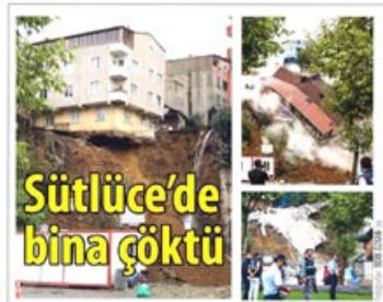
Sütlüce'de bina çöktü İSTANBUL Sütlüce'de bir temel açma çalışması sırasında toprak kayması yaşandı. Bu sebeple, yanda bulunan 4 katlı binanın temeli havada asılı kaldı. Güvenlik tedbirleri için bina ve çevresinde bulunan apartmanlar boşaltıldı. Bina bir süre sonra büyük bir gürültüyle çöktü. ► HABERİ SAYFA 12'DE
